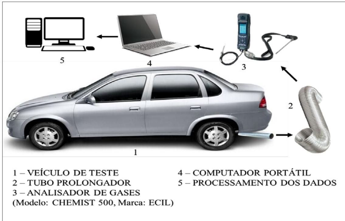
Figura 2. Esquema de montagem dos equipamentos utilizados.
